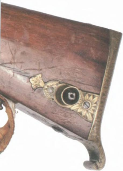
Detailansicht einer Windbüchse Österreich, um 1850 von Dasch in Graz gefertigt Vierkant zum Spannen der Windlade, Stecherabzug Grifflaub mit drei Fingerrillen davor Entriegelungshebel zum Abkippen des Laufes Daumenauflage mit Fischhaut (geriffelte Fläche) oNr/3.644
