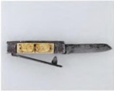
KLAPPMESSER FÜR EINEN HUFSCHMIED Allzweckklinge mit Ätzverzierung und Federsicherung sowie eine Aderlassklinge, Heftrücken als Feuereisen, Beinschalen mit Gravierung: Vorderseite zeigt einen Hufschmied bei der Arbeit, Rückseite mit nicht mehr leserlichem Spruch, wohl Sterzing, Südtirol, 19. Jh. Inv.Nr. 27.855
