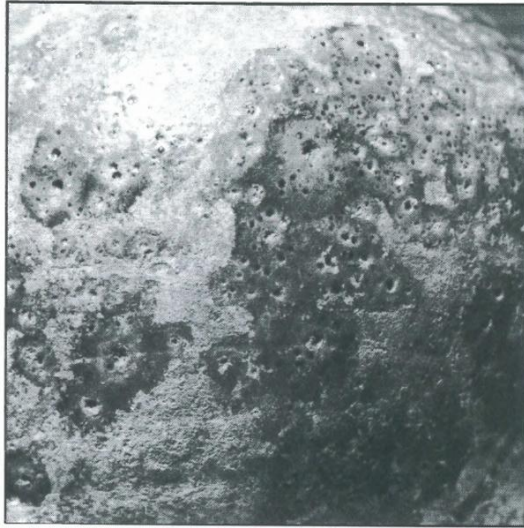
Abb. 8: Entstehung von Bleisilikaten mit niedriger Viskosität an der Berührungsstelle von Bleioxyd und Scherbenmaterial.
